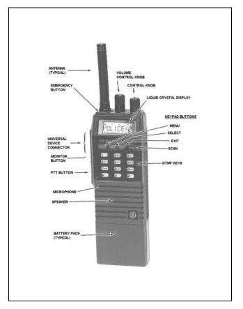
VOLUME CONTROL KNOB ANTENNA (TYPICAL) CONTROL KNOB EMERGENCY BUTTON LIQUID CRYSTAL DISPLAY KEYPAD BUTTONS - MENU UNIVERSAL DEVICE ——— CONNECTOR - SELECT EXIT SCAN MONITOR BUTTON PTT BUTTON MICROPHON SPEAKER BATTERY PACK (TYPICAL)
